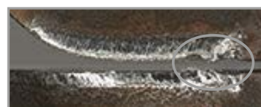
Wykruszenia krawędzi skrawającej
